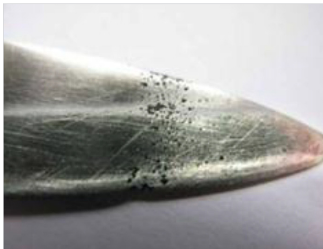
Рис. 3. Питтинговая коррозия [12] Fig. 3. Pitting corrosion [12]
