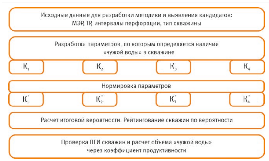
Рис. 2. Основные положения методики подбора кандидатов на ремонтно-изоляционные работы Fig. 2. The main provisions of the methodology for selecting candidates for repair and insulation work
