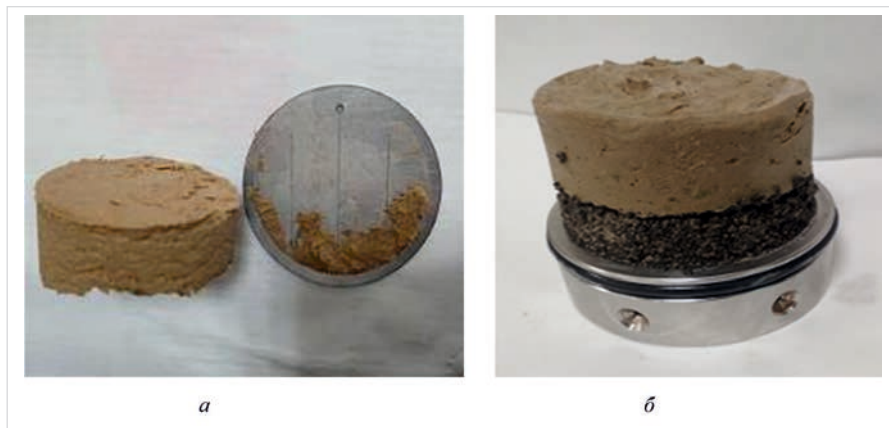
Рис. 1. Внешний вид фильтрационной корки после проведения фильтрационного тестирования на модели щели 150 мкм — а, насыпной модели из проппанта 16/20 — б Fig. 1. The appearance of the filtration crust after filtration testing on the 150 μm slit model — a and the bulk model made of proppant 16/20 — б
