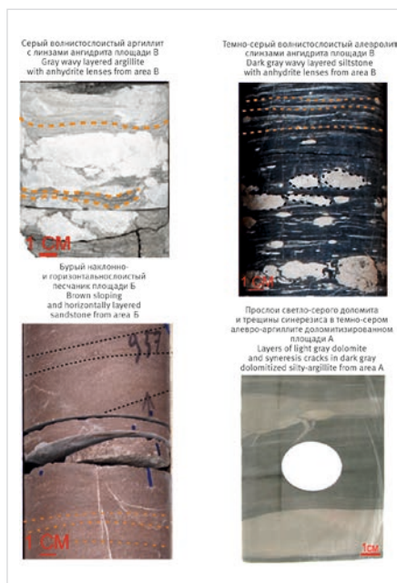
Рис. 10. Образцы отложений III седиментационного цикла редколесной свиты Fig. 10. Deposits samples of the 3rd sedimentation cyclite of the redkolesnaya formation
