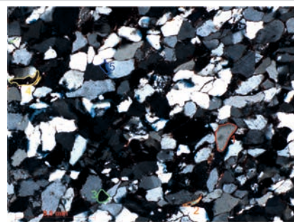
Песчаник мелкозернистый (николи скрещены, увеличение 100х, глубина 2 713,18 м) Fine-grained sandstone (crossed Nicoli, 100x magnification, depth 2 713,18 m)
