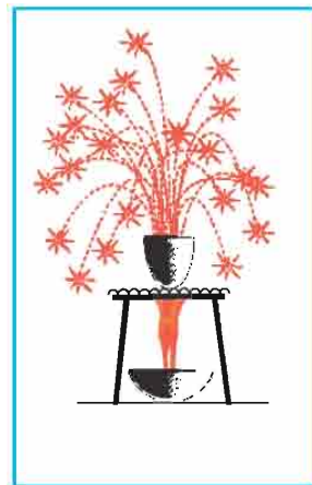
Рис. 15. Восстановление оксида железа с помощью алюминия
