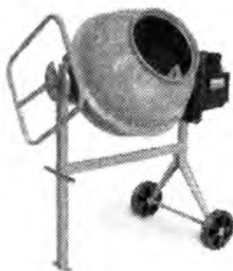
3.1-rasm. Laboratoriyada qorishma tayyorlash uchun ishlatiladigan baraban tipidagi va silindrik idishli betonqorgichlar
