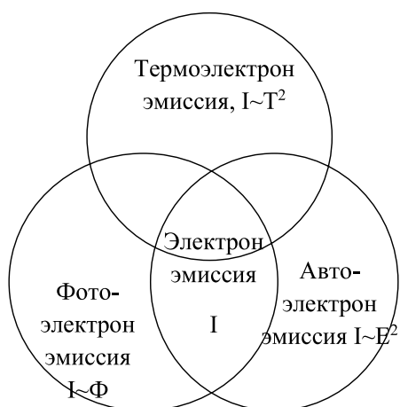
6-расм. Электрон эмиссия турлари.
