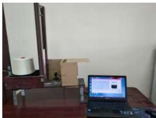
1-бобина, 2 и 3 нитенаправитель, 4- горизонтальное основание, 5-неподвижный зажим, 6-пряжа, 7-установленный светоотражающий шар, 8-подвижный зажим, 9-устройство запускающее в работу подвижный зажим, 10- веб камера, 11- основание веб камеры, 12-основной опорный стол, 13- груз, 14-компьютер.
