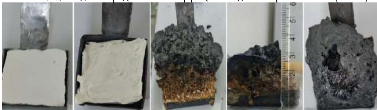
Рис. 2. Вспучивание полимерных композиционных материалов на основе акриловых сополимеров под воздействием температуры.
