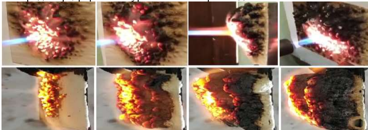
3-расм. Ёнғиндан ҳимояловчи қавариқланадиган қопламанинг кокс ҳосил қилиш механизми.
