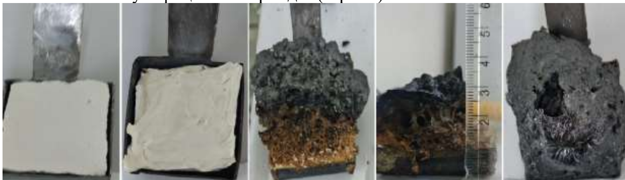
2-расм. Акрил сополимер асосидаги полимер композит материалларни ҳарорат таъсирида қавариқланиши.
