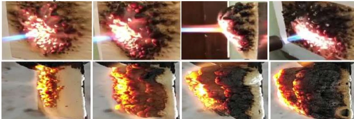
Рис. 3. Механизм коксообразования пожарозащитного вспучиваемого покрытия.
