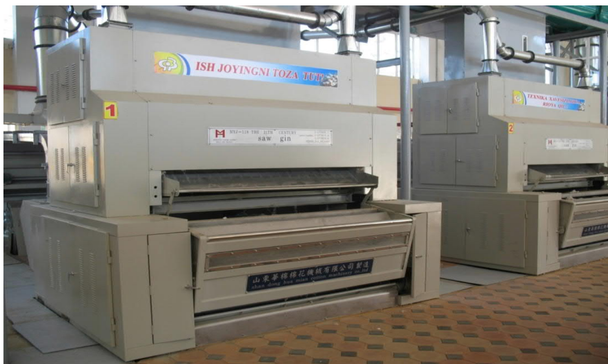
1.10-rasm. Arrali jinlar o‘rnatilgan qatorning umumiy ko‘rinishi
