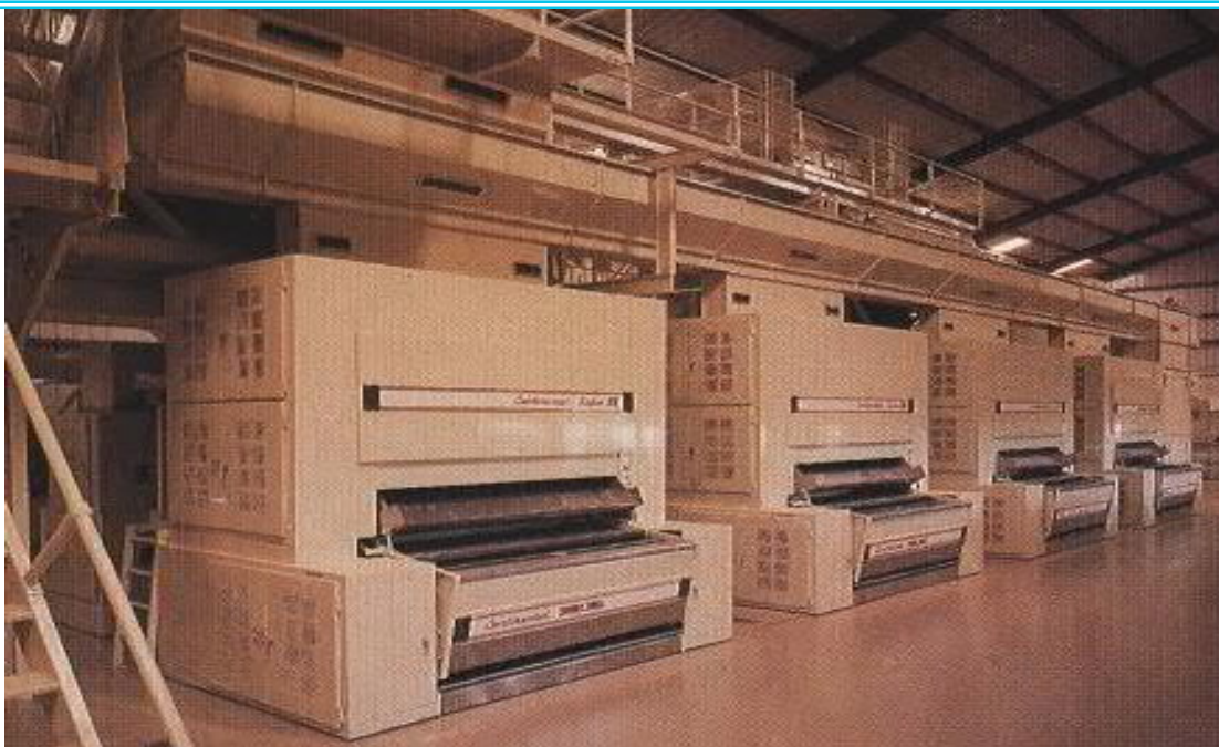
1.8-rasm. Arrali jinlar oʻrnatilgan qatorning umumiy koʻrinishi
