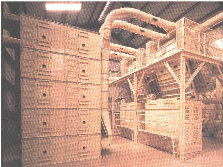
1.6- rasm. Chigitli paxtani quritish va tozalash uskunarining umumiy ko'rinishi
