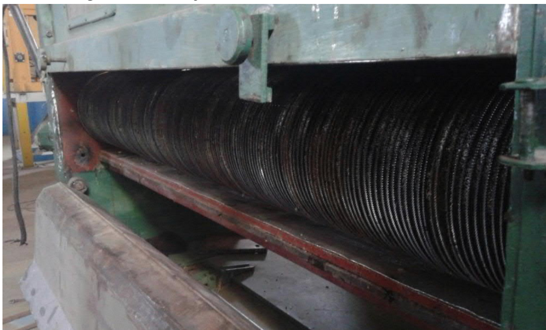
3.5-rasm. Kombinatsiyalangan arra-metall cho‘tkali silindrning umumiy ko‘rinishi
