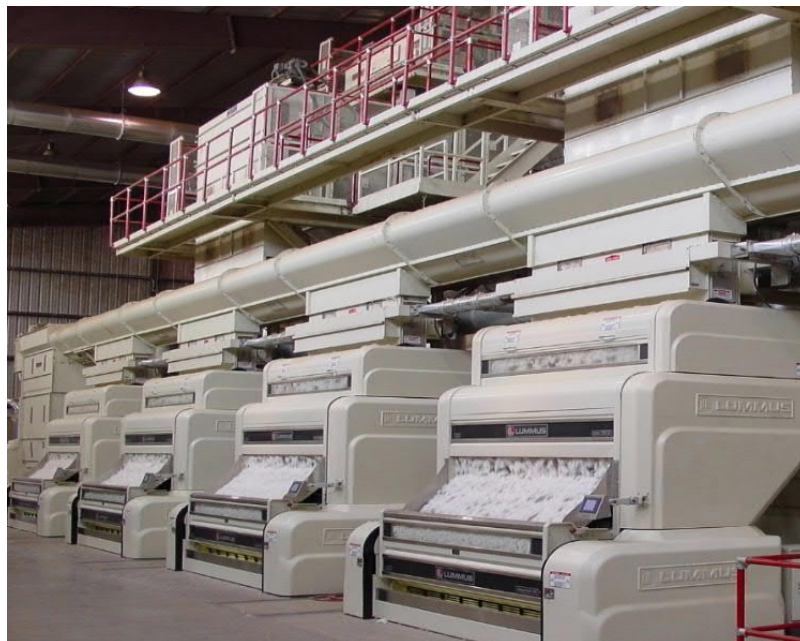
4.2-rasm. Arrali jinlar o‘rnatilgan qatorning umumiy ko‘rinishi
