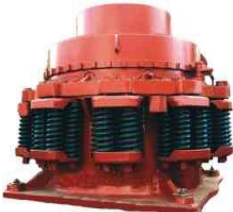
11-rasm. KSD-1750T rusumli o'rta maydalaydigan konusli maydalagich.
