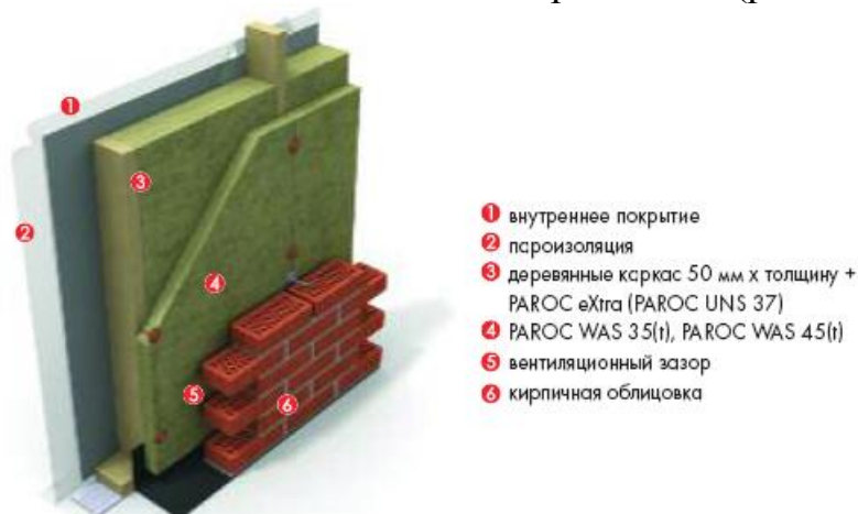
Рис. 4.6. Каркасная конструкция с кирпичной облицовкой
