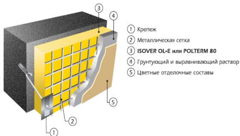
Рис. 4.4. Утепление фасада теплоизоляционной системой с толстослойной штукатуркой
