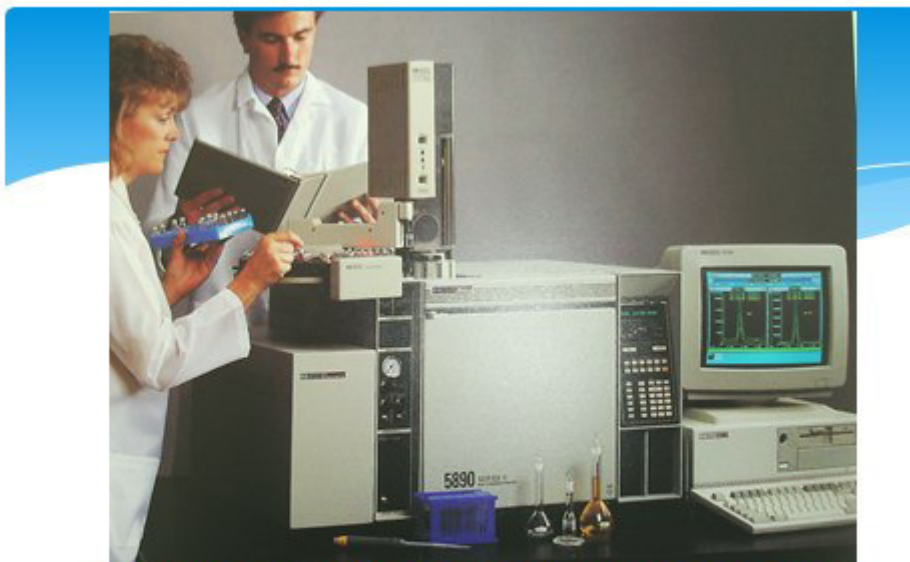
Аналитикалық лабораторияда қолданылатугын Газ хроматограф HP 5890 (фирма Хьюлетт-Паккард)
