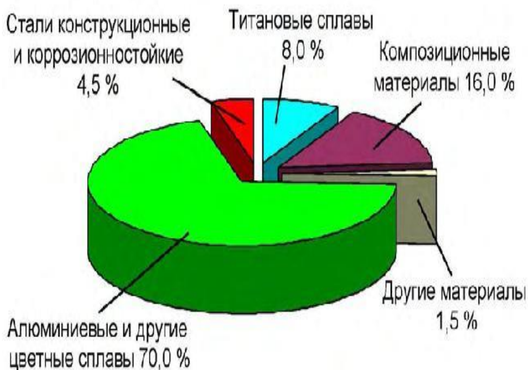
Рис 2. Конструкционные материалы, применяемые в авиастроении
