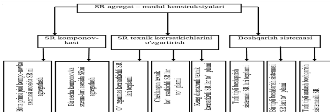
3.1– rasm. Sanoat robotlarini agregat - modul qurishning struktura sxemasi.
