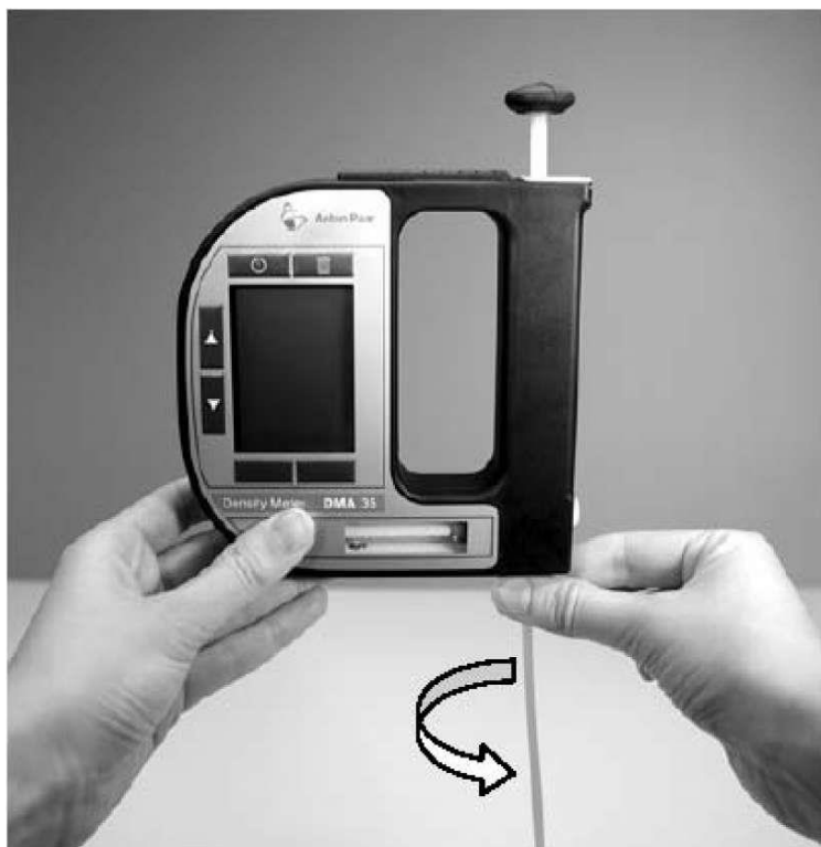
12-rasm. DMA35 markali densinometrغا namuna joylashtirish trubkasini o'rnatish
