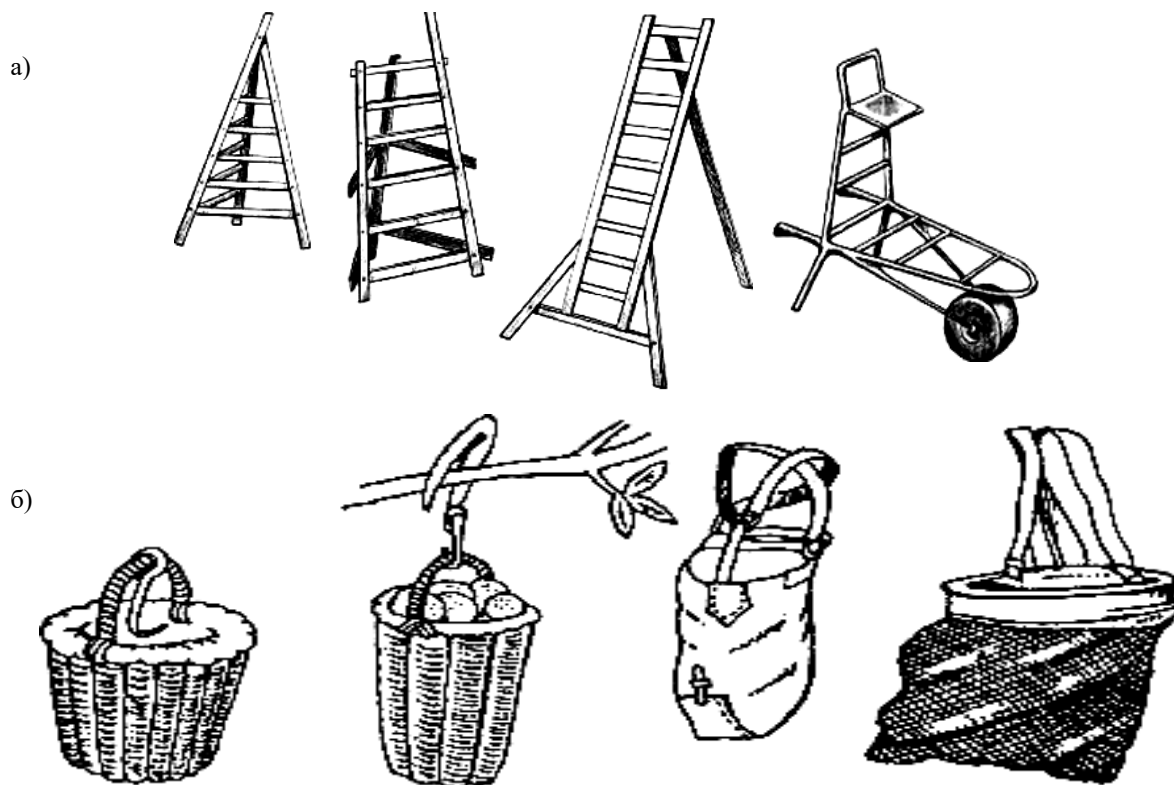
3-rasm. Mevalarni terib olishda foydalaniladigan narvon (a) va savat (b) turlari
