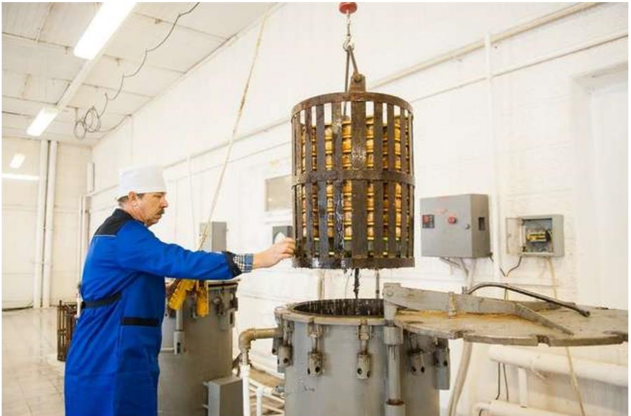
45-Rasm. Konservalarni bankalarga joylab, sterilizatsiya qilish jarayoni
