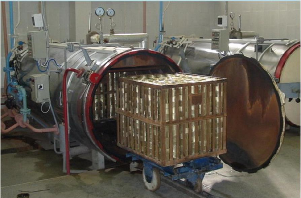
46-Rasm. Konservalarni bankalarga joylab, sterilizasiya qilish jarayoni
