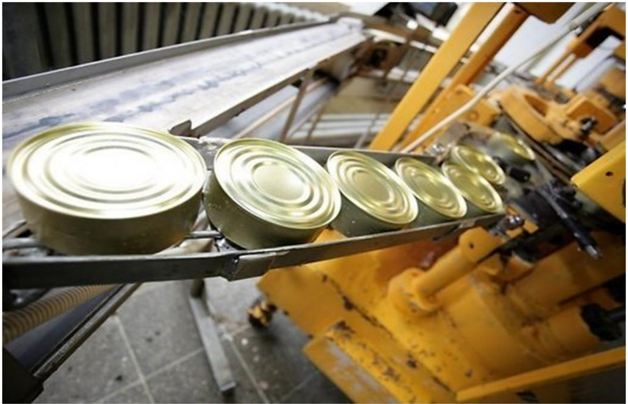
44-Rasm. Konservalarni bankalarga joylab, yopish jarayoni
