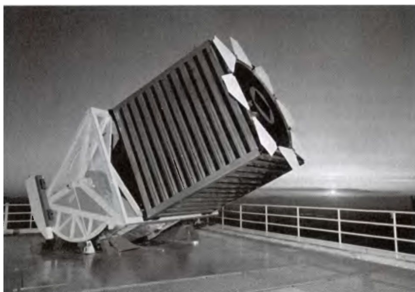
5-rasm. Apach poynt observatoriyasidagi (Nyu Meksiko shtati) Sloan Fondining ixtisoslashtirilgan 2,5-metrli keng burchakli teleskopi. Uning yordamida 2000-2005 yillarda shimoliy koinotning Sloan ko'p rangli va spektral obzori o'tkazildi.
