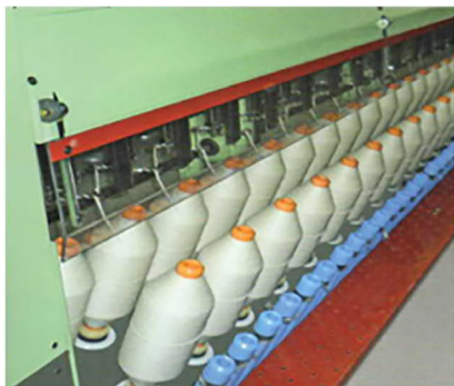
3.1-rasm. G'altak novini og'dirib qo'lda syomga tayyorlash
