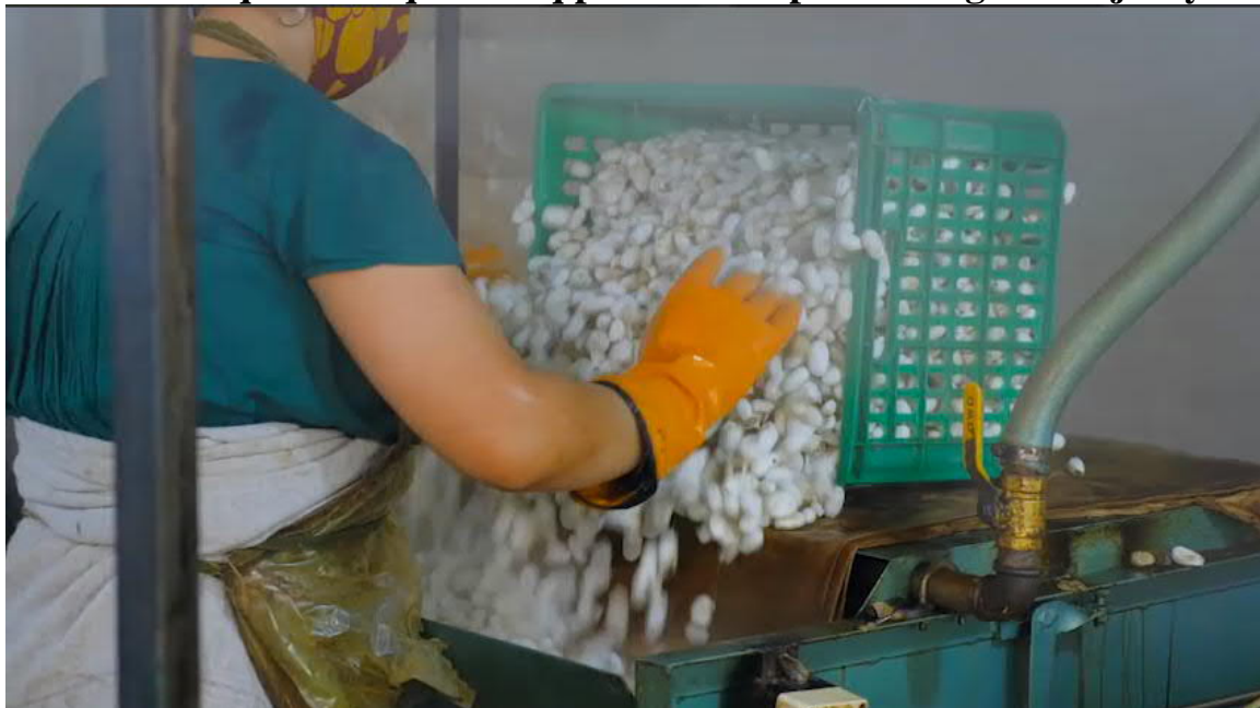
5.5-rasm. Ipak momig'ini qaynatishga tayyorlash jarayoni
