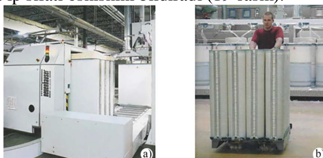
19-rasm. To'g'ri to'rtburchak tazlarning avtomatik a) va qo'lda b) transportirovkasi
