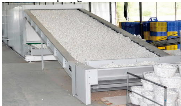
6.2-rasm. FY 521 vakuum pilla bug'lash qurilmasi
