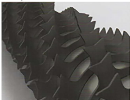
2.4-rasm. UNifloc 11 avtotitkichning ishchi valigi
