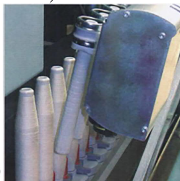
3.7-rasm. SERVOGrip qurilmasi a) va ROBOdoff syom tizimi b)
