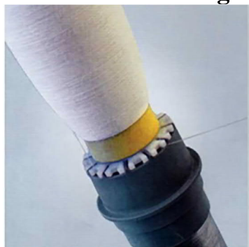
3.7-rasm. SERVOGrip qurilmasi a) va ROBOdoff syom tizimi b)
