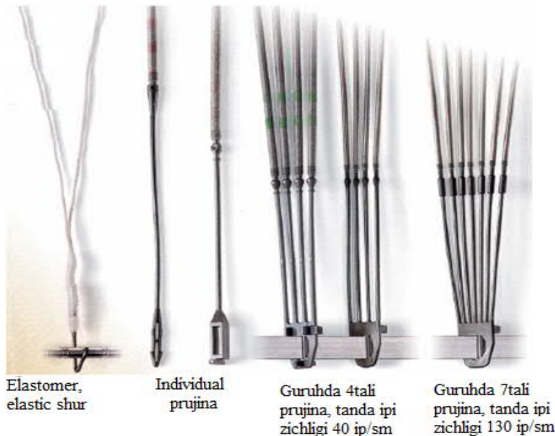
36-rasm. Tanda iplarini pastga tushirish elementlari
