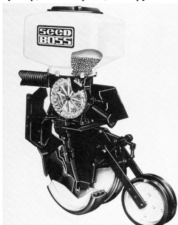
38-расм. White Farm Equipment фирмасининг пневматик миқдорлагич аппарати.
