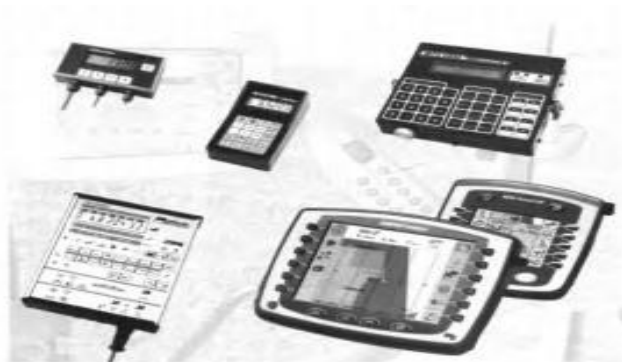
2-rasm. Bort kompyuterining variantlari: oddiy Hektarzahler (yuqorida chapdagi) Komfort-Terminal ISO-BU Myuller-elektronika uchun va John Deere kompaniyasi traktori kompyuteri.
