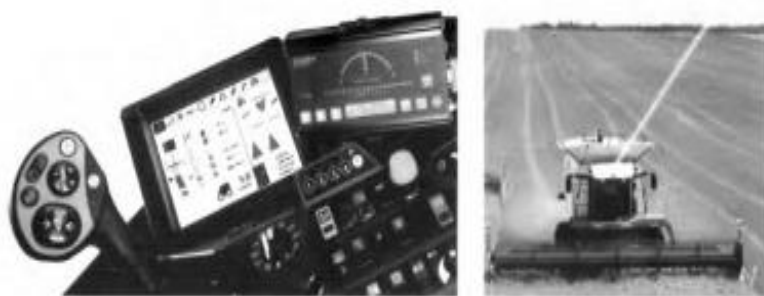
1-rasm. Klaas kompaniyasi “Lexion” kombaynini bort kopyuteri
