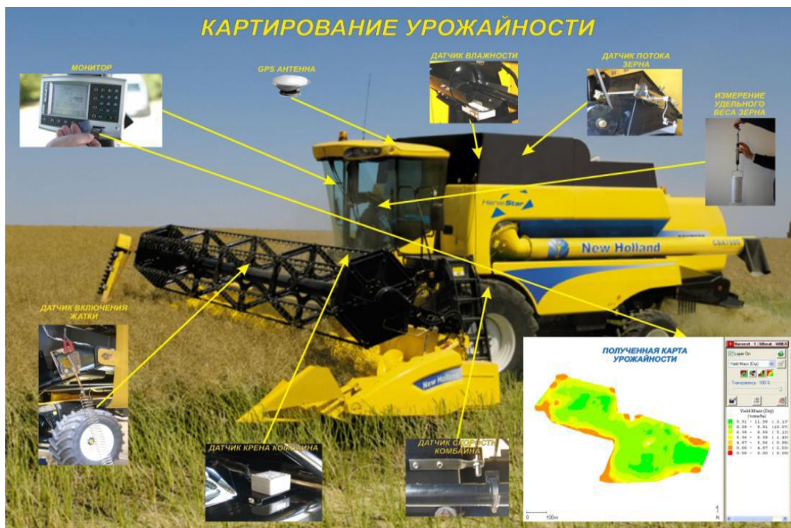
3-расм. Комбайнда ҳосилдорликни хариталаш тизими асбобларининг жойлашиши ва олинган ҳосилдорлик харитаси
