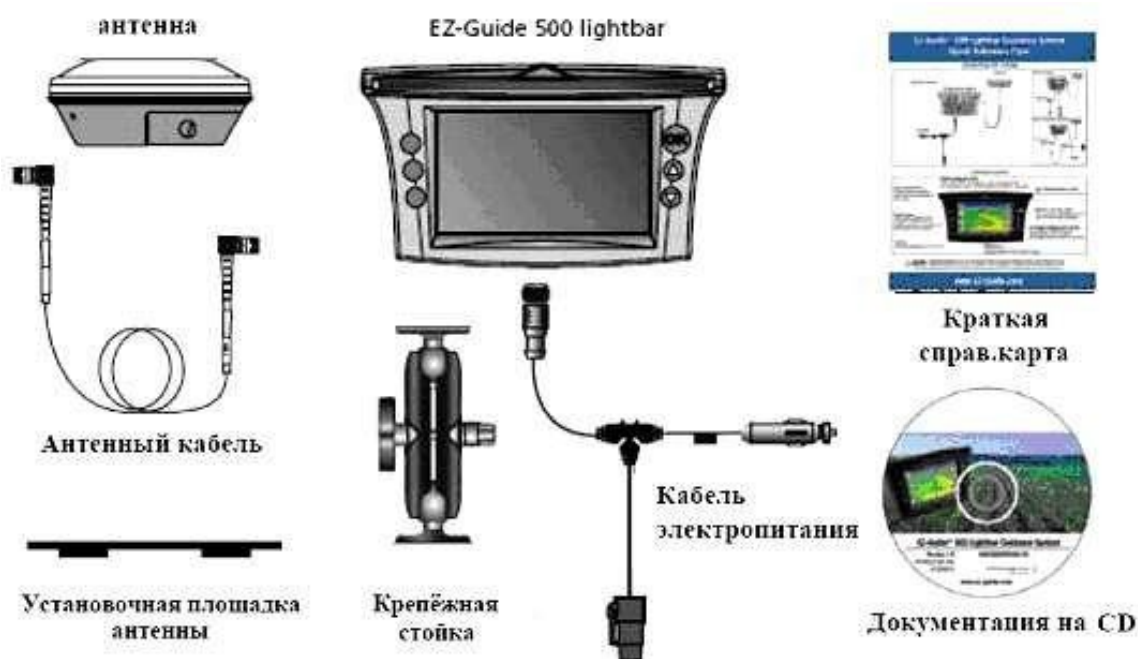
Расм 13. Параллел ҳаракатланиш тизимининг стандарт ташкил этувчилари
