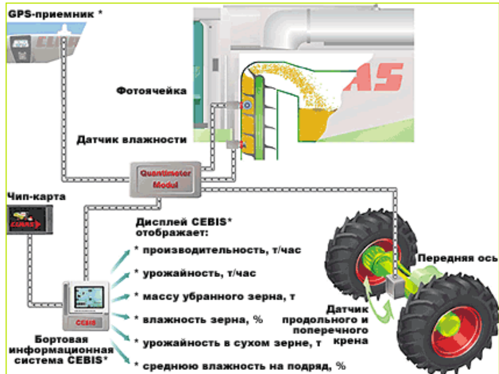
6-расм. Ҳосилдорликни мониторинглаш тизими қурилмаси элементлари схемаси
