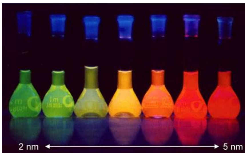
4.10-rasm. Har xil o'lchamdagi (2 dan 5 nm gacha, chapdan o'ngga) kolloid CdTe zarralari suspenziyalarining floresansi. Barcha lampalar yuqoridan bir xil to'lqin uzunligidagi ko'k nur bilan yoritilgan.
