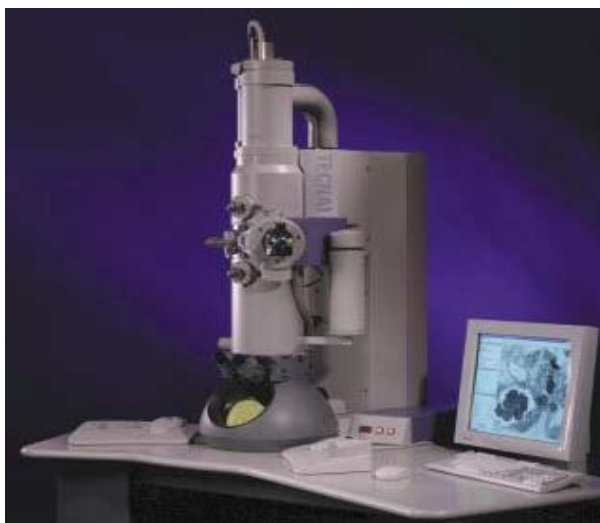
8-rasm. Biologik tadqiqotlarda ishlatiladigan transmission (yoritib ko'ruvchi) elektron mikroskoplarni ko'rinishi.
