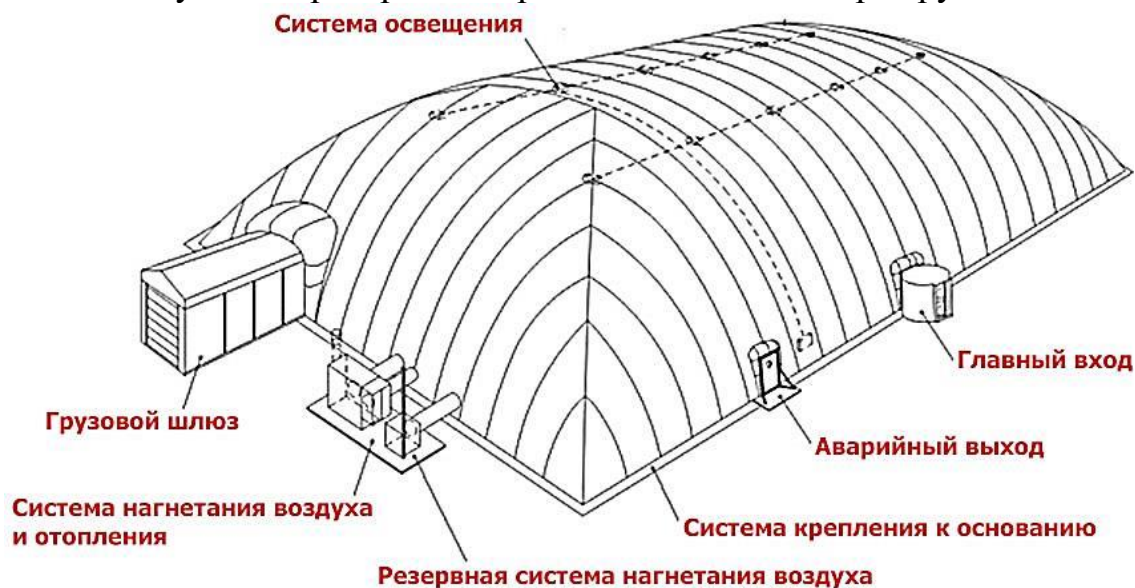
Рис. 2.51. Устройство пневматического воздухоопорного покрытия
