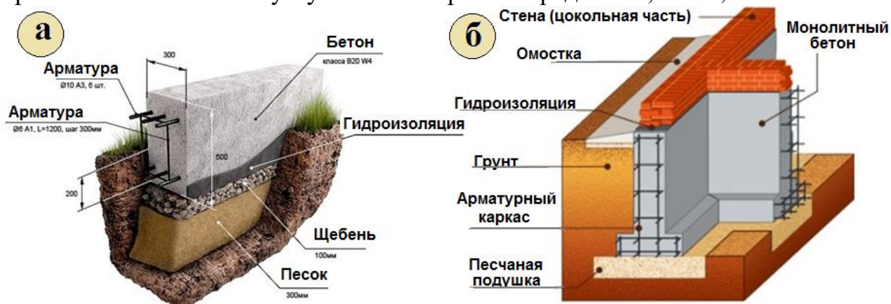
Рис. 1.36. Типы ленточных фундамента по форме поперечного сечения: а – прямоугольный; б – ступенчатый
