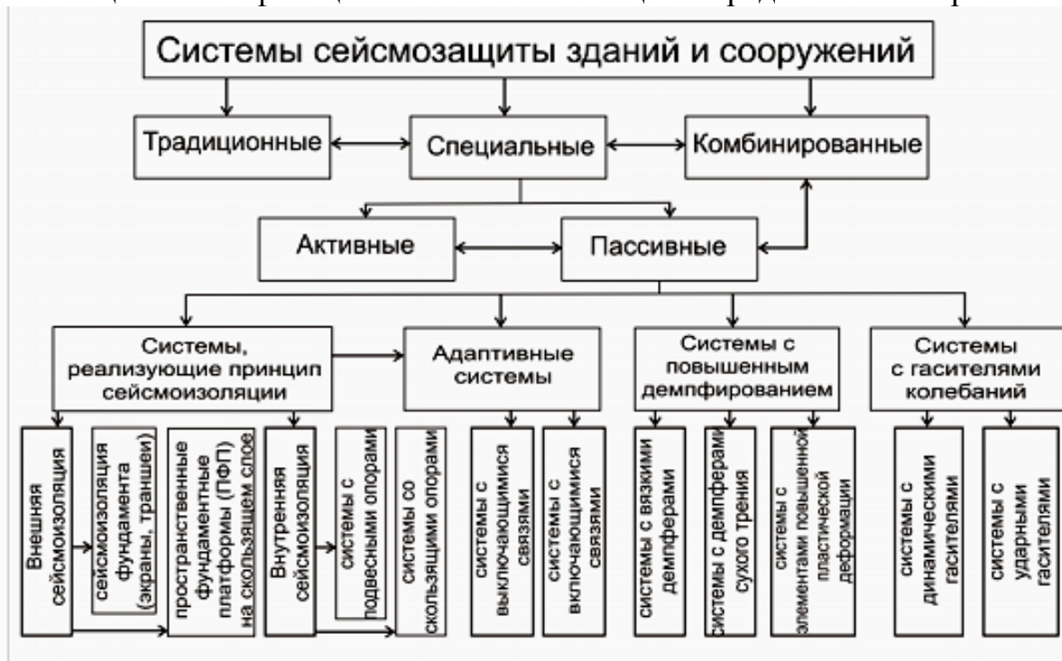
Рис. 3.12. Классификация систем сейсмозащиты по принципу их работы
