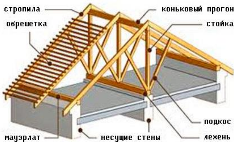
Рис. Пр1.22. Покрытие по наслонным стропилам
