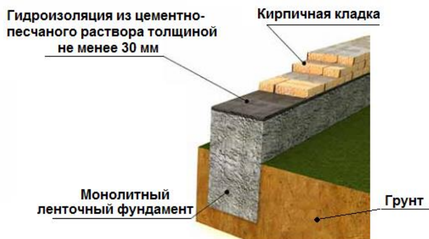
Рис. 3.6. Устройство горизонтальной гидроизоляции стен
