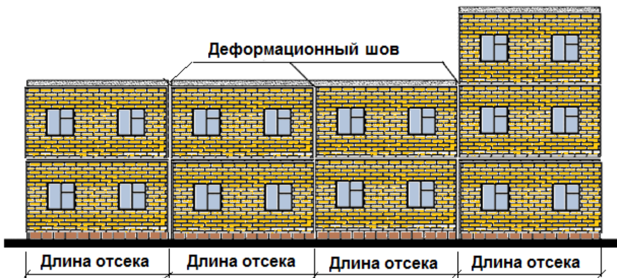
Рис. 1.25. Деление здания вертикальными деформационными швами на отсеки
