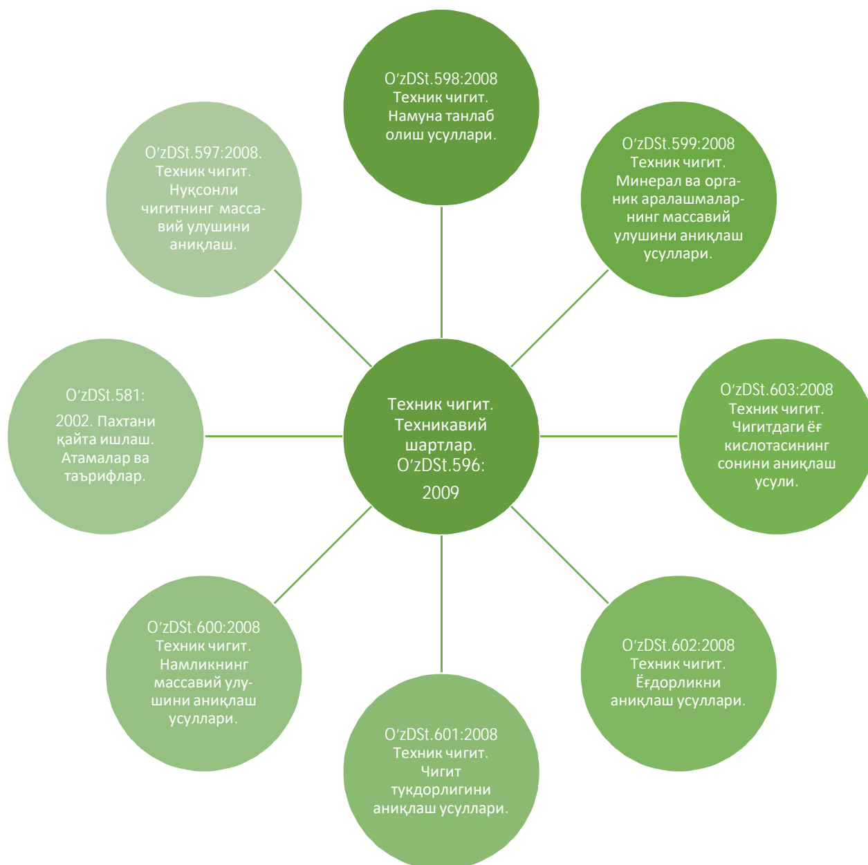
3.4-rasm. Texnik chigitning texnikaviy shartlari negizida bir-biri bilan uzviy bog‘langan va qo‘llaniladigan asosiy standartlar
