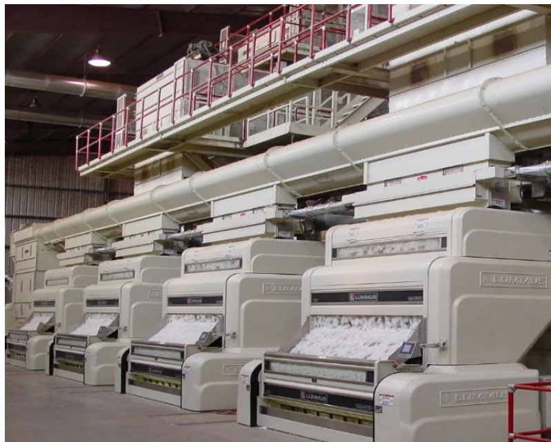
4.2-rasm. Arrali jinlar o‘rnatilgan qatorning umumiy ko‘rinishi
