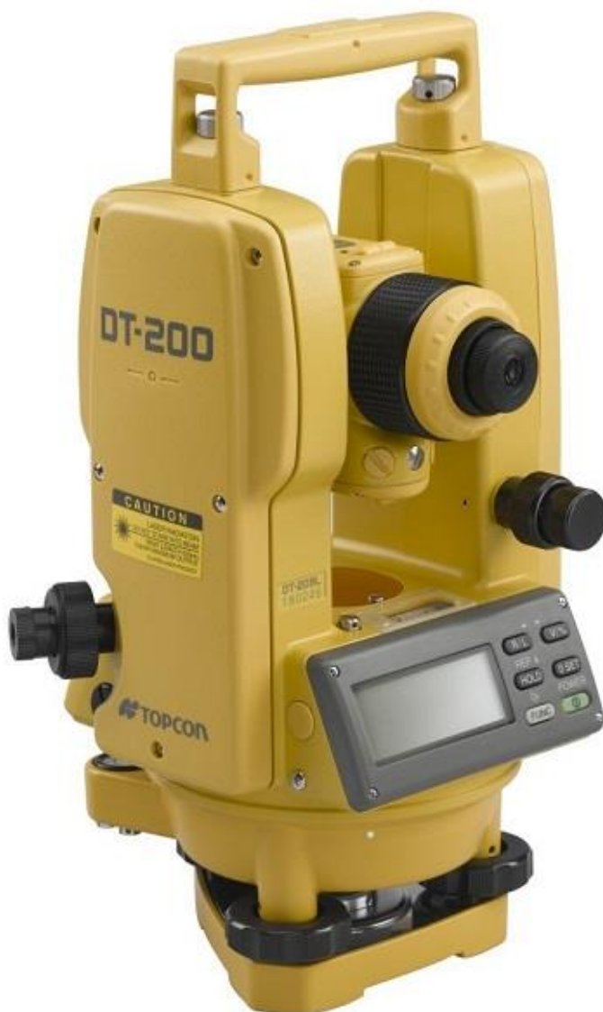
2.1-rasm. Geodezik-marksheyderiya sohasida keng qo‘llaniladigan yuqori aniq optik-elektron teodolit
