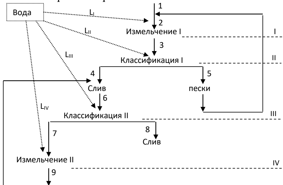
1 Rasm. Ikki bosqichli silliqlash sxemasi
