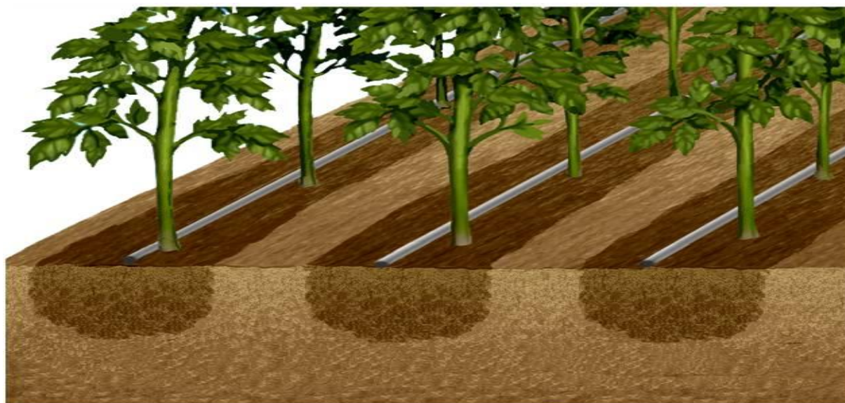
2.3-rasm. Tomchilatib sug'orish tizimida tuproqning namlanish chegarasining umumiy ko'rinishi.
