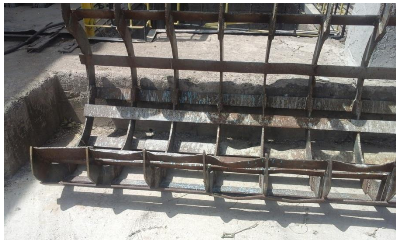
3.20 - расм. Қўқим тозалаш механизми ва унинг ишчи органи
