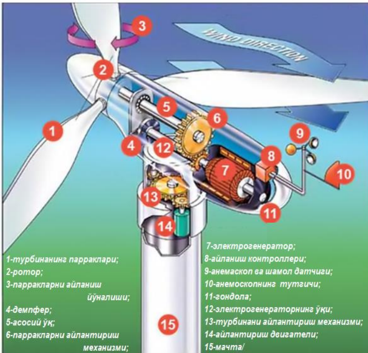
52-расм. Шамол энергоқурилмаларининг тузилиши.
