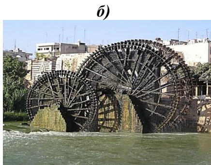
5-расм. Гидравлик энергия ёрдамида ҳаракатга келадиган чархпалаклар: а-Суриянинг Ҳамд шаҳридаги диаметри 22 м ва сув сарфи- Q = 4800 л /мин. нория-чархпалак; б-оддий чархпалак.
