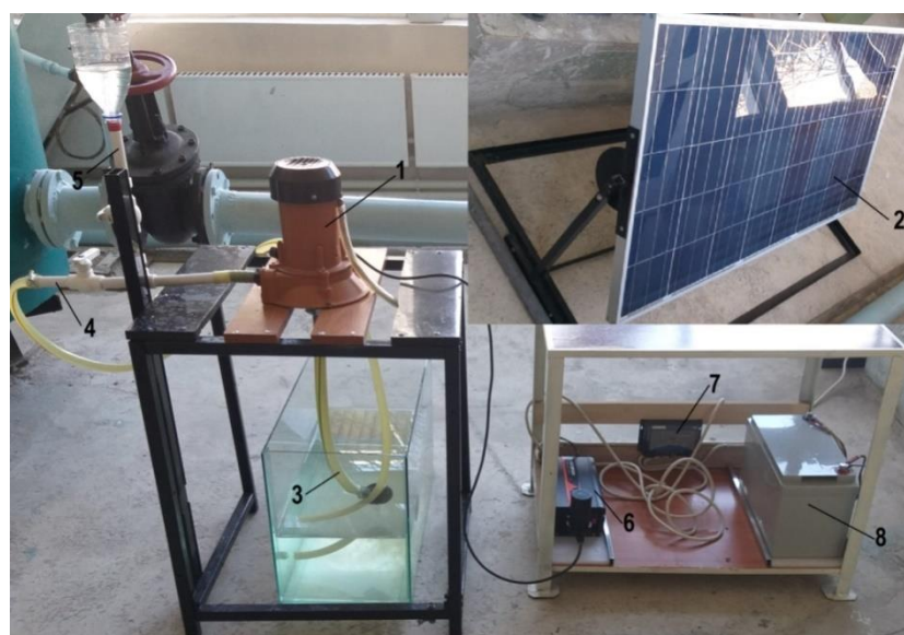
5.12-расм. Қуёш панели энергияси ёрдамида сув кўтарувчи “Агидель” насос қурилмаси:
