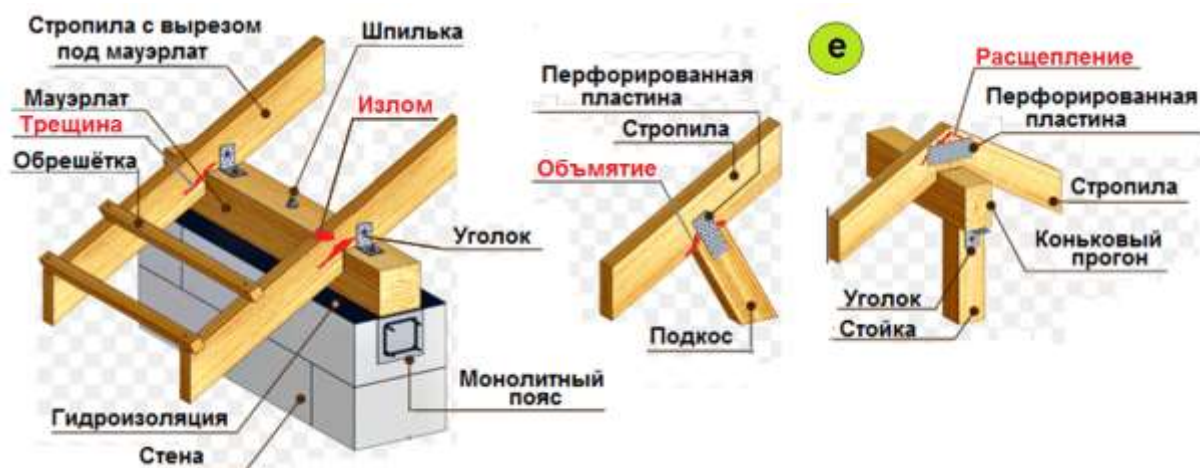
Рис.Пр2.6. Повреждения деревянных конструкций:
