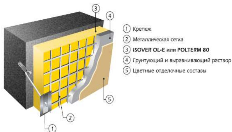
Рис. 4.4. Утепление фасада теплоизоляционной системой с толстослойной штукатуркой
