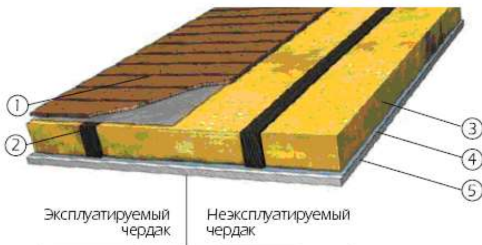
Рис. Пр7.9. Конструктивное решение утепления чердачного перекрытия:
