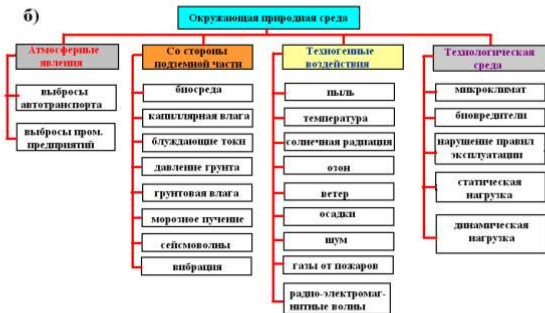
Рис.4.1. Факторы, вызывающие износ и старение конструкций здания: а) виды воздействий; б) структурная схема воздействий на здание агрессивных факторов
