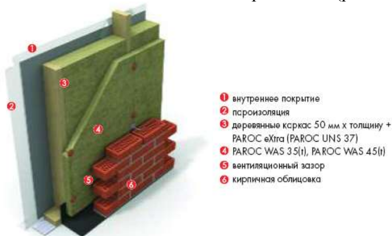
Рис. 4.6. Каркасная конструкция с кирпичной облицовкой
