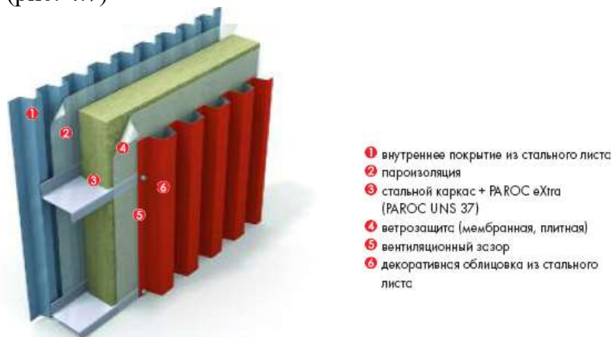
Рис. 4.7. Каркасная конструкция утепления для промышленных Зданий
