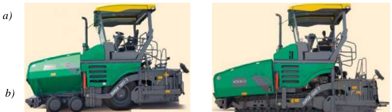
20-rasm. Xozirgi zamon asfaltobeton qarishmasini yo‘lga yotqizuvchi mashinalar: a) rezina g‘ildirakli; b) gusenitsali.
