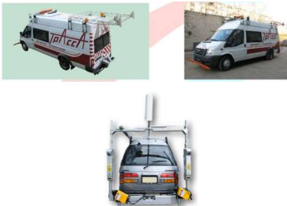
5-rasm. Avtomobil yo‘llarini diagnostikasini amalga oshiruvchi ixtisoslashtirilgan ko‘chma laboratoriyalar
