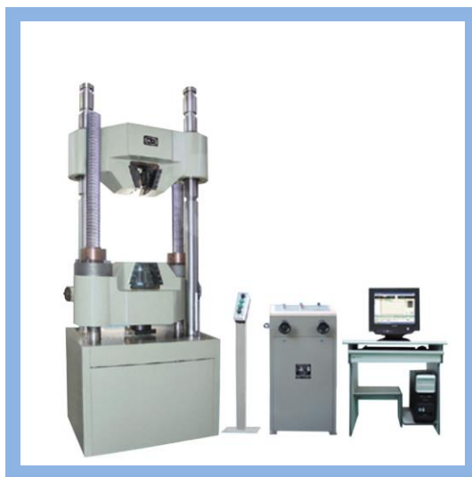
1.1-rasm Materiallarni cho‘zilishga va siqilishga mustaxkamligini aniqlashga mo‘ljallangan qurilma
