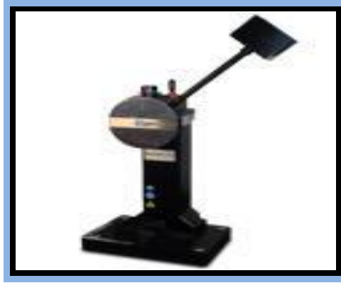
2.1-rasm. Mayatnikli kopyor” materiallarni zarbiy qovushoqligini aniqlashda ishlatiladigan qurilma
