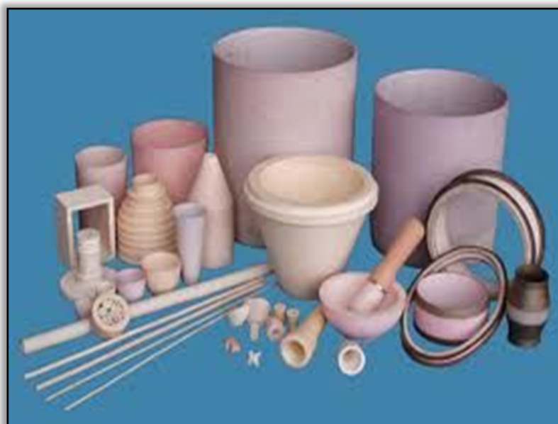
3.1.6-rasm. Alyumosilikatdan tayyorlangan olovbardosh buyumlar (tigel, lodochka, trubkalar).
