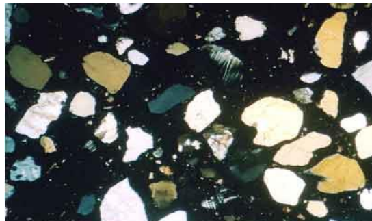
8-Rasm B . Sement plitkasini mikrorasmlari – qora rangdagi asosiy massa – magnezial sement, yirik donali oq rangli zarrachalar – dala shpatlari, slyudalar tarkibida tutgan qum minerallari. kattalashtirish darajasi 25\times . O‘tqazuvchi nur, nikollar kesishga xolda.
