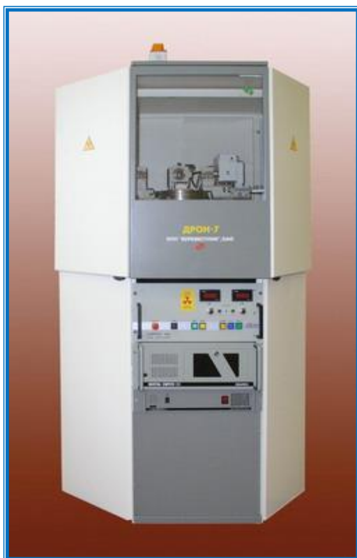
17 rasm. DRON-7 rentgen difraktometri va rentgen trubkasi.
