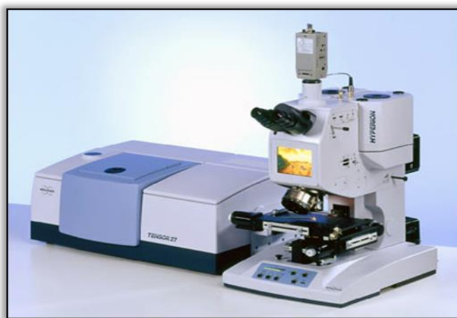
21- rasm. Furye-IQspektrometri Bruker Vertex 70.
