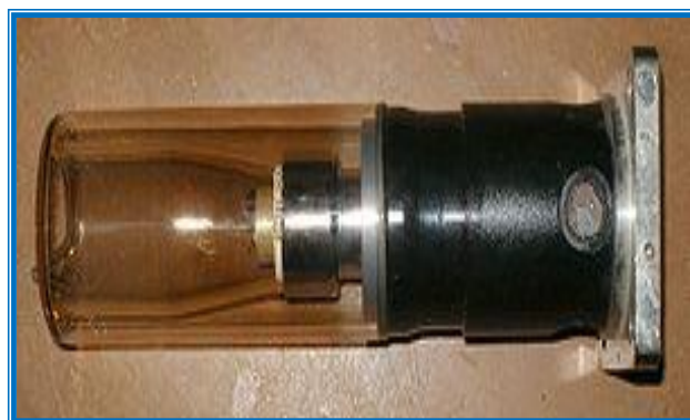
17 rasm. DRON-7 rentgen difraktometri va rentgen trubkasi.
