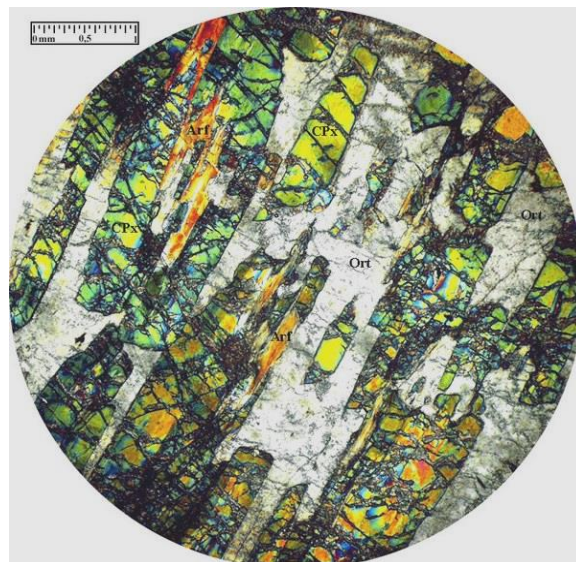
5 rasm. Pegmatit mineralining polarizatsion mikroskopda olingan tasviri. A- mineralning ko'rinishi, B – mikroskopda olingan tasviri. (Yakutiya, Aldan).
