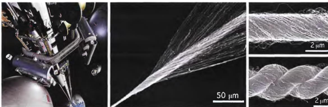
Rasm 14. Nanonaychalarni mikrotasvirlari 39
