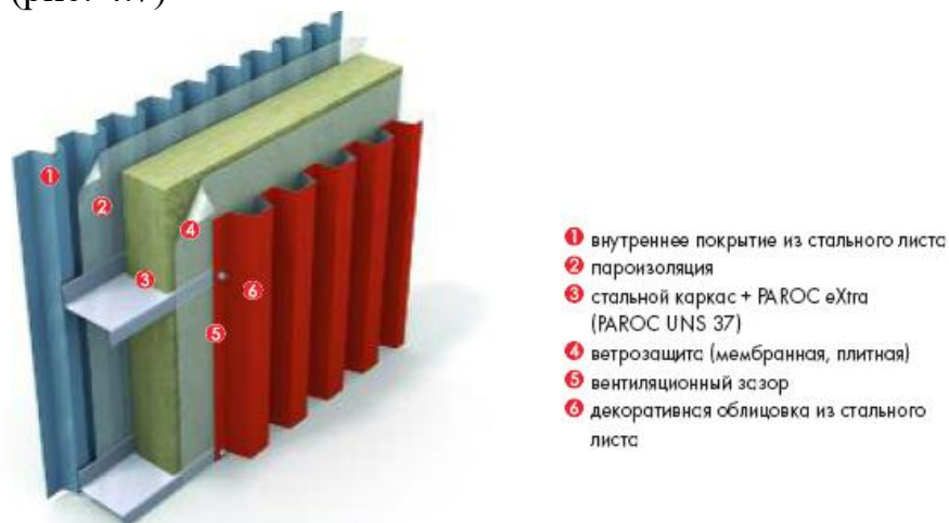
Рис. 4.7. Каркасная конструкция утепления для промышленных Зданий
