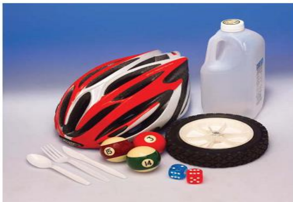
Rasm 2.5. Polimer materiallardan tayyorlangan oddiy maxsulotlar – plastik oshxona jixozlari (qoshiq, sanchqi va pichoq), bilyard shari, velosiped shlemi, ikkita o'yin kubiki, o't o'rish uskunasi g'ildiragi (plastmassali disk va rezinali shina) va plastik idish.
