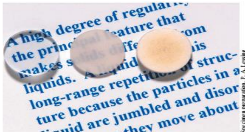
Rasm. 1.2. Alyumin oksididan tayyorlangan uchta ingichka disklar surati
