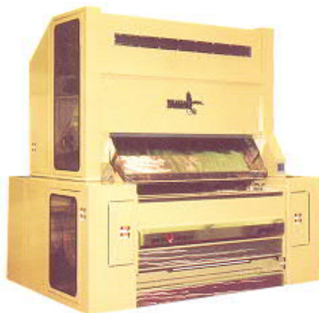
1-rasm. Ustiga Extractor-Feeder Model-2000 o'rnatilgan 161- arrali jinning umumiy ko'rinishi
