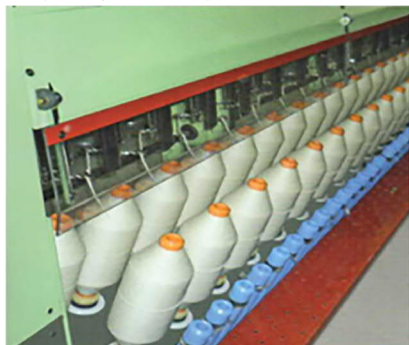
1-rasm. G'altak novini og'dirib qo'lda syomga tayyorlash
