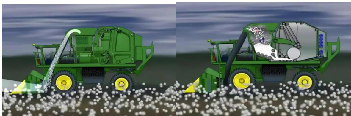
3-rasm. Mashina kombaynida paxtani birinchi seksiyadan ikkinchi seksiyaga o'tish jarayoni
