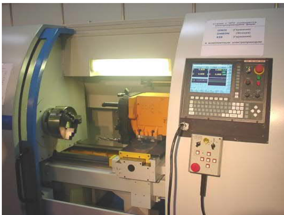
3.5- rasm. Tokarli SDB dastgohini a) umumiy ko'rinishi, b) sxemasi .
