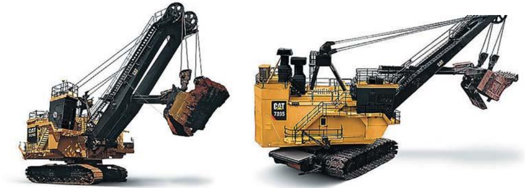
Ris. 4. Sat 7295 va Cat 7395 to'g'ri lopatali karyer mexanik ekskavatorlari
