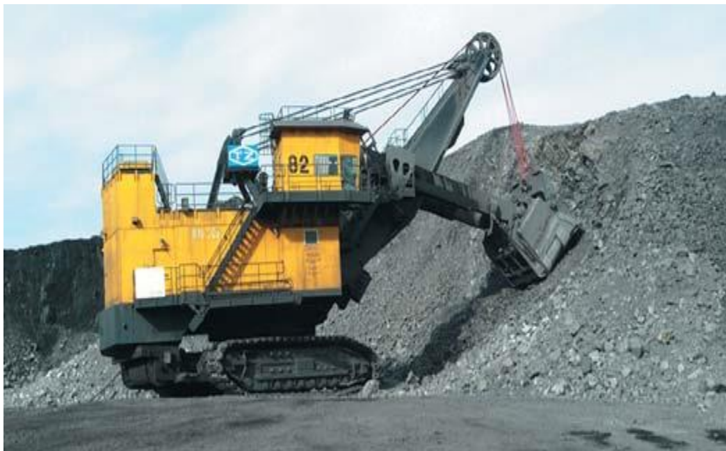
Ris.8. Bachatsk ko'mir razrezida ishlatilayotgan Tayyuanskogo zavodida ishlab chiqarilgan WK-35 ekskavatori
