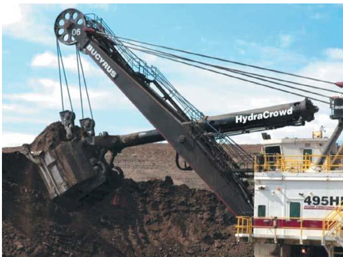
1-rasm. Saterpillar kompaniyasining «HydraCrowd» gidravlik kuch beruvchi mexanizmlı 495HF karyer mexanik ekskavatori
