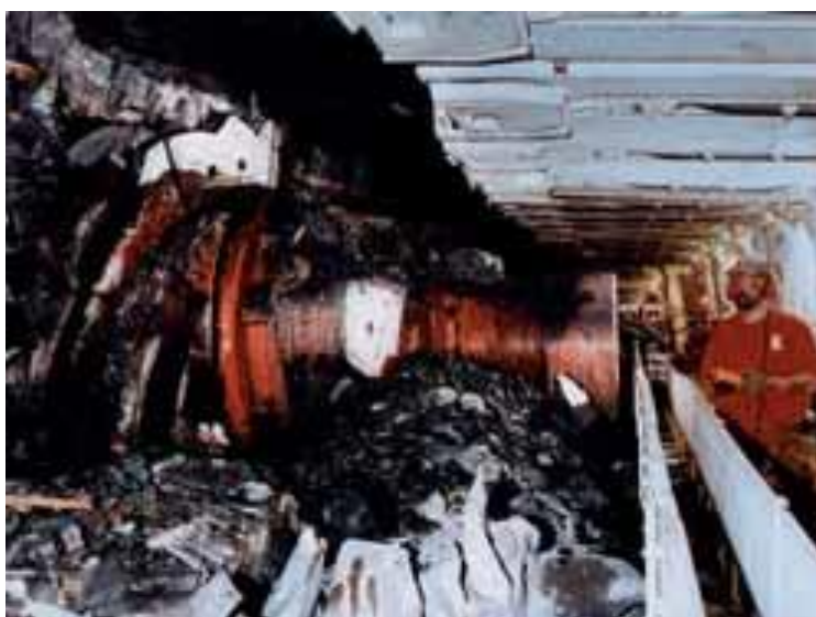
12-rasm. DBT firmasi tomonidan (Germaniya) ishlab chiqilgan zamonaviy yuqori unumdorlikli qazib olish kombayni
