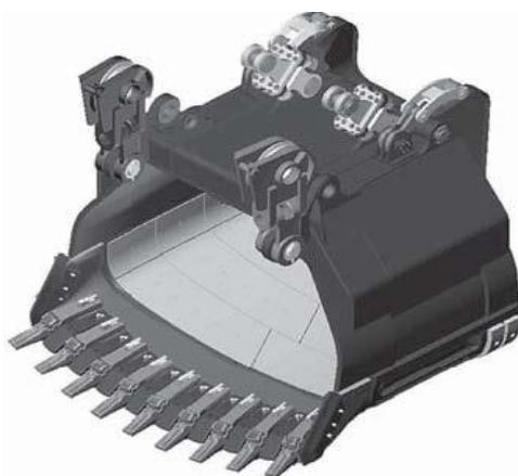
Ris. 3. Optimallashtirilgan geometriyali FastFil konstruksiyali kovsh
