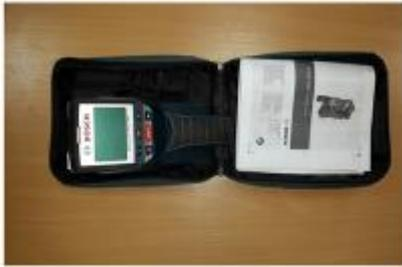
Измеритель защитного слоя бетона
