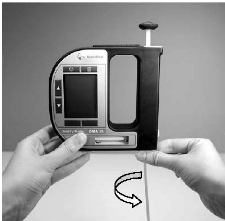
12-расм. DMA35 маркали денсинометрга намуна жойлаштириш трубкасини ўрнатиш
