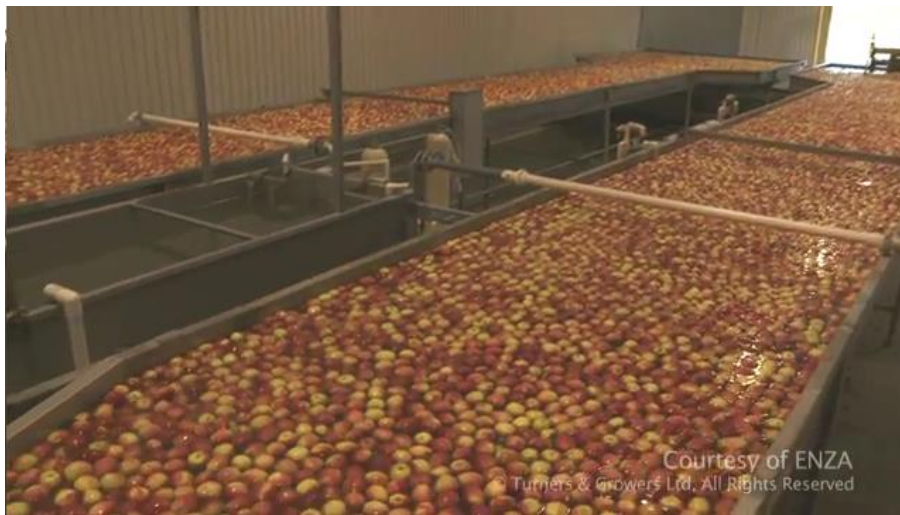
1.2.-расм. Меваларни инспекция қилиш ва саралаш
