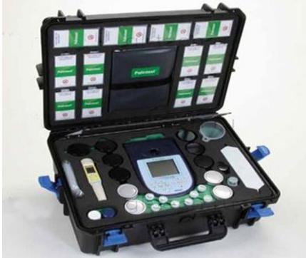
SKW 400 va SKW 500 тупроқтарни таҳлил қилиш бўйича мини лаборатория. Ушбу туплам билан лаборатория ва дала шароитида тупроқдаги микроэлементларини таҳлил қилиш мумкин
