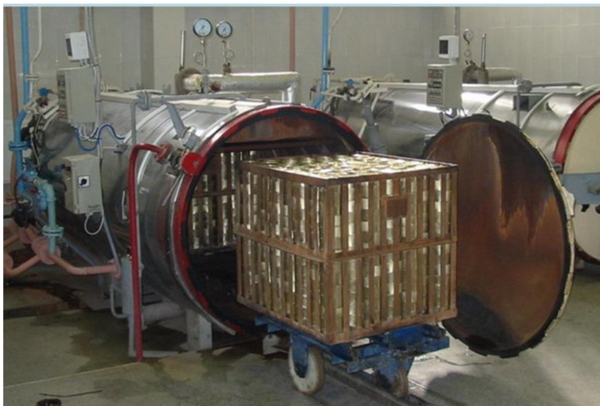
46-Расм. Консерваларни банкаларга жойлаб, стерилизация қилиш жараёни
