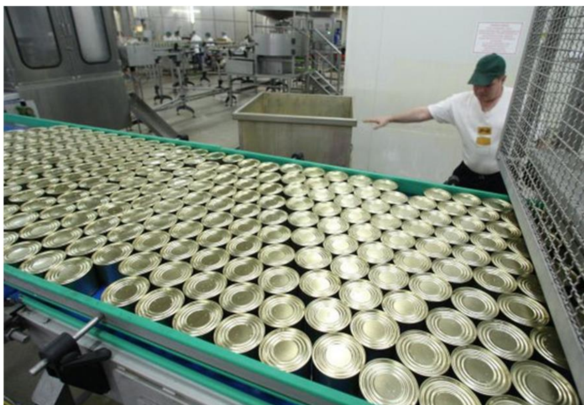
47-Расм. Консерваларни банкаларга жойлаб, стерилизация қилиш жараёни
