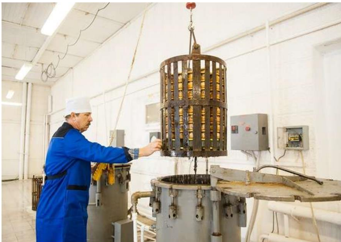
45-Расм. Консерваларни банкаларга жойлаб, стерилизация қилиш жараёни
