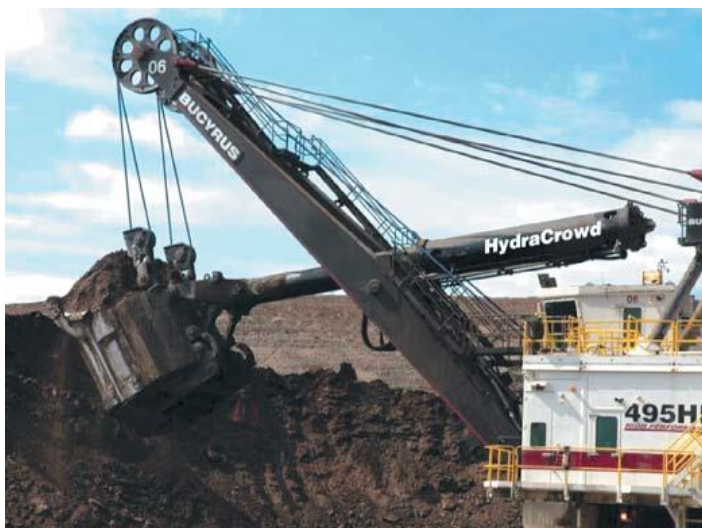
1-расм. Caterpillar компаниясининг «HydraCrowd» гидравлик куч берувчи механизмли 495HF карьер механик экскаватори
